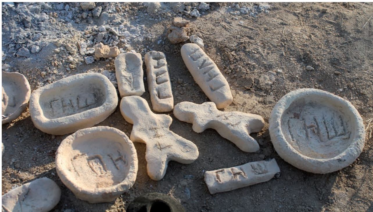
Рис. 6. Экспериментальные образцы керамики, обожженные в наземном очаге.
