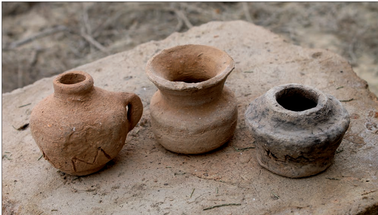
Рис. 5. Экспериментальные образцы керамики, обожженные в горне расплавленного саксаулом.
