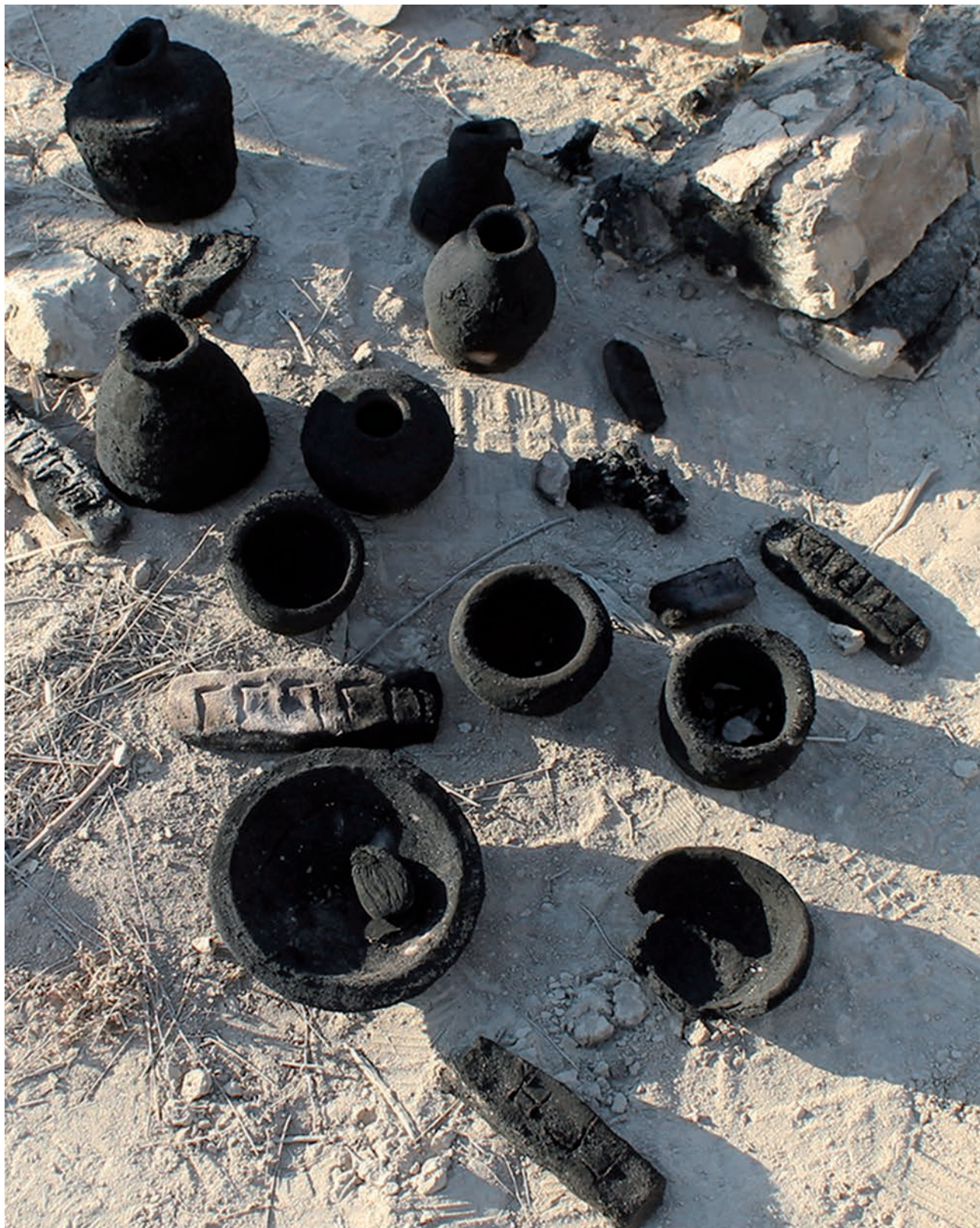
Рис. 4. Экспериментальные образцы керамики, обожженные в горне расплавленного сырым полукустарником.
